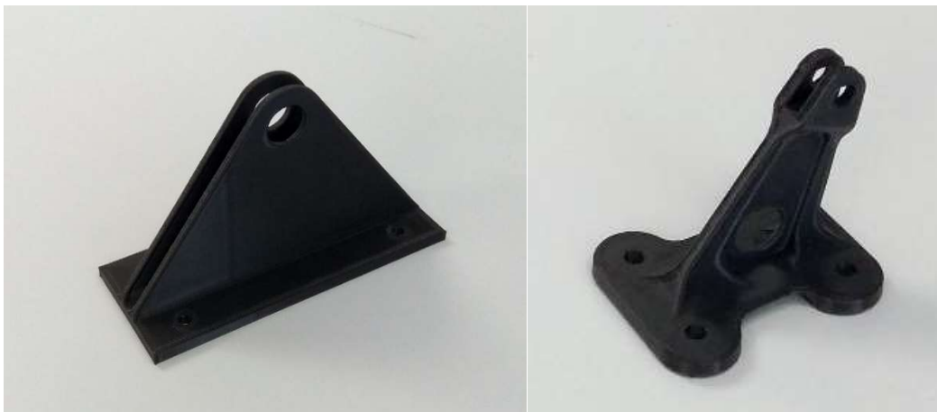
Рисунок 9 – Результаты тестовой печати технологических 3D-моделей: а) Кронштейн 02, б) Кронштейн 03
