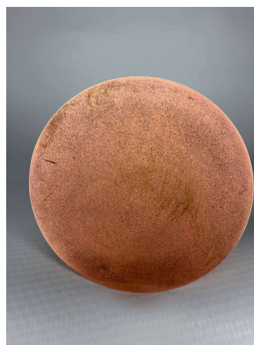
Рисунок 2 – Дефектный образец прутка М06 диаметром 50мм после водородного отжига
