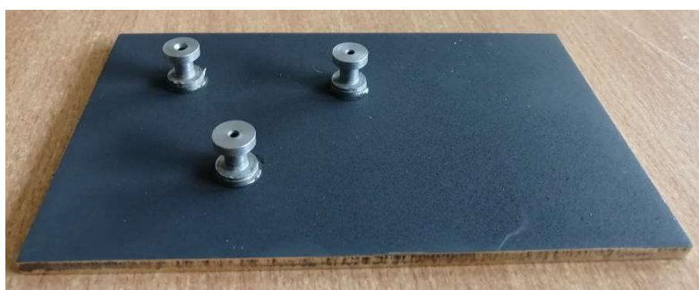
Рисунок 7 - Специальные элементы (грибки) приклеенные к покрытию
