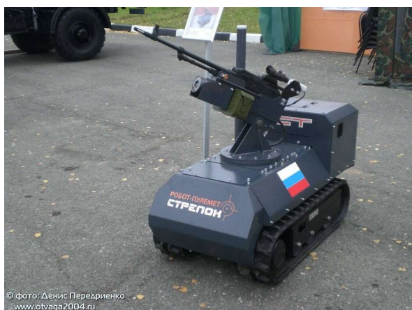
Рисунок 6 – НРТК «Стрелок» с автоматизированным модулем огня на базе ПКП 7,62x39
