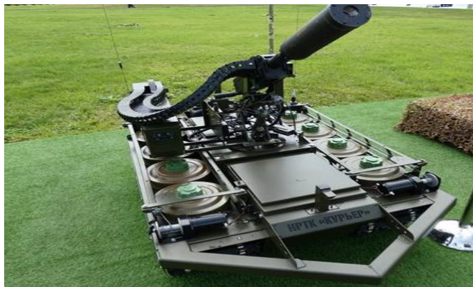
Рисунок 5 – НРТК «Курьер» с автоматизированным модулем АГС-17 и конвейерами миноукладчиками
