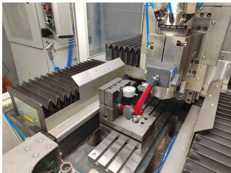
Рисунок 6 – Пример выравнивания УСП
