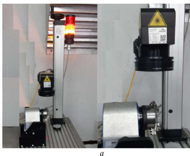
Рисунок 4 – Модифицирование поверхности методом лазерной абляции:
