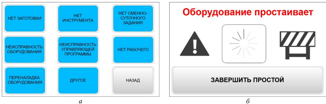
Рисунок 3 – Пример интерфейса панели оператора ИИС: а – окно причин простоя; б – окно простоя
